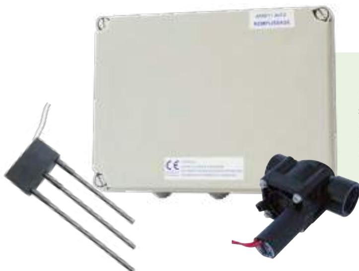
Le **régulateur de niveaux électronique SKIMREGUL TOP** est à positionner en **partie supérieure du skimmer** (entre margelle et skimmer). Les sondes en inox peuvent être sectionnées en fonction du niveau d'eau souhaité dans le bassin.
